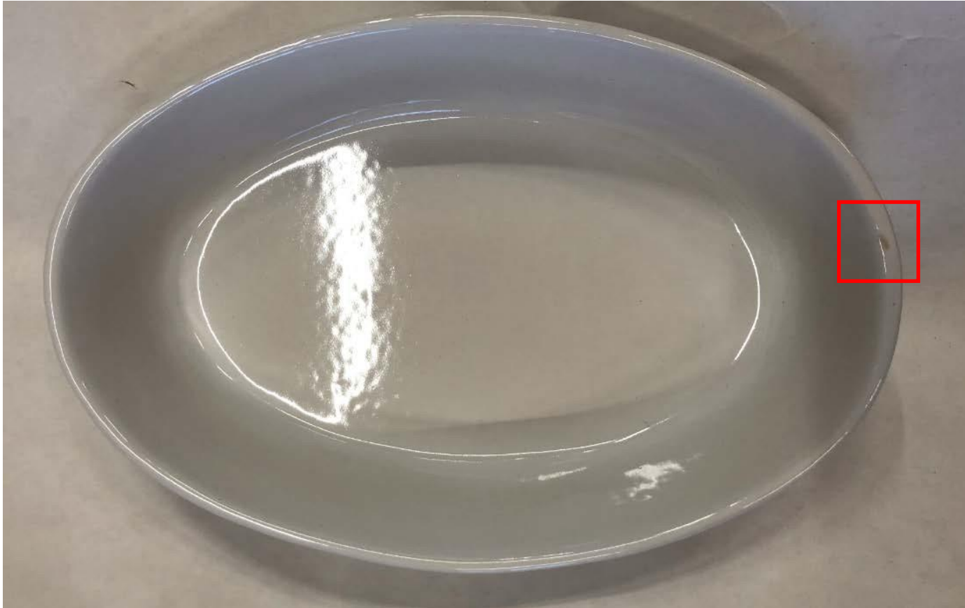
Заметные потемнения на лицевой стороне товара
