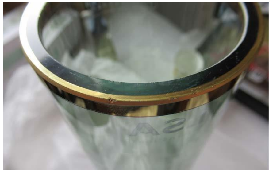
Неровности на ободке / на крае
