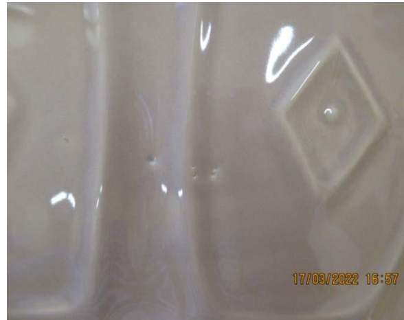
Многочисленные углубления и / или вмятины, неровности, сколы на керамике
